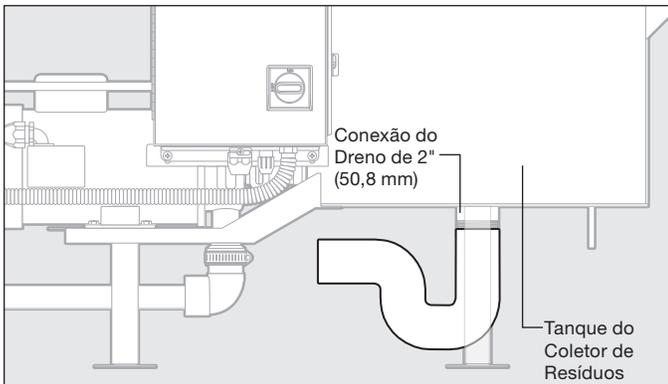
Figura 11. Tubulação de Drenagem
