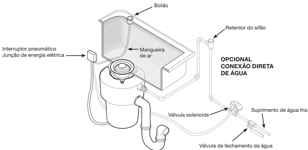
OBSERVAÇÃO: O interruptor pneumático comercial InSinkErator (Peça No. 13754) está disponível apenas para o modelo 120V.
